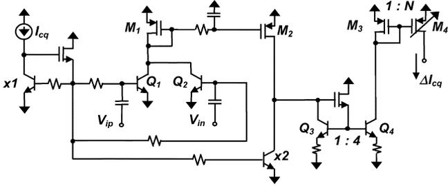
Fig. 16. Power-detector bias-control circuit.
